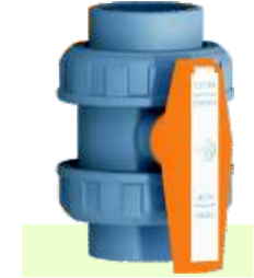
U-P.V.C. Küresel Asit Vanası U-P.V.C. Acid Ball Valve Dişli / Female Thread Basınç / Pressure : PN 10 Küre Contası / Seals : TEFLON O-Ringler / O-Rings : EPDM
