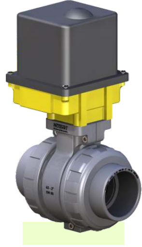
U-P.V.C. Küresel Asit Vanası U-P.V.C. Acid Ball Valve Yapıştırma / Solvent Basınç / Pressure : PN 10 Küre Contası / Seals : TEFLON O-Ringler / O-Rings : EPDM
