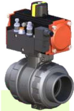
U-P.V.C. Küresel Asit Vanası U-P.V.C. Acid Ball Valve Dişli / Female Thread Basınç / Pressure : PN 10 Küre Contası / Seals : TEFLON O-Ringler / O-Rings : EPDM
