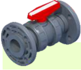
U-P.V.C. Küresel Su Vanası U-P.V.C. Water Ball Valve Basınç / Pressure : PN 10 Küre Contası / Seals : HDPE O-Ringler / O-Rings : EPDM
