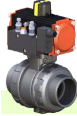
U-P.V.C. Küresel Asit Vanası U-P.V.C. Acid Ball Valve Yapıştırma / Solvent Basınç / Pressure : PN 10 Küre Contası / Seals : TEFLON O-Ringler / O-Rings : EPDM
