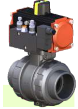
U-P.V.C. Küresel Asit Vanası U-P.V.C. Acid Ball Valve Yapıştırma / Solvent Basınç / Pressure : PN 10 Küre Contası / Seals : TEFLON O-Ringler / O-Rings : EPDM
