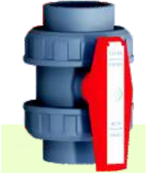
U-P.V.C. Küresel Su Vanası U-P.V.C. Water Ball Valve Dışlı / Female Thread Basınç / Pressure : PN 10 Küre Contası / Seals : HDPE O-Ringler / O-Rings : EPDM
