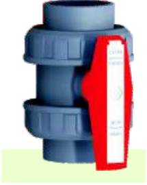
U-P.V.C. Küresel Su Vanası U-P.V.C. Water Ball Valve Yapıştırma / Solvent Basınç / Pressure : PN 10 Küre Contası / Seals : HDPE O-Ringler / O-Rings : EPDM
