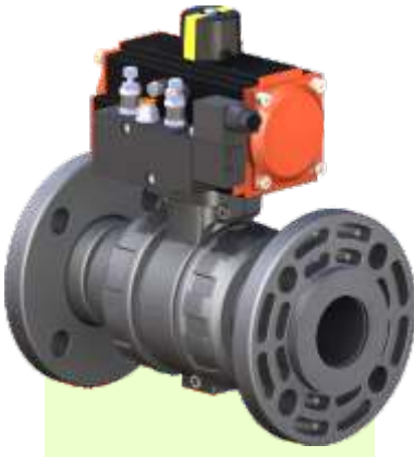
U-P.V.C. Küresel Asit Vanası U-P.V.C. Acid Ball Valve Basınç / Pressure : PN 10 Küre Contası / Seals : TEFLON O-Ringler / O-Rings : EPDM
