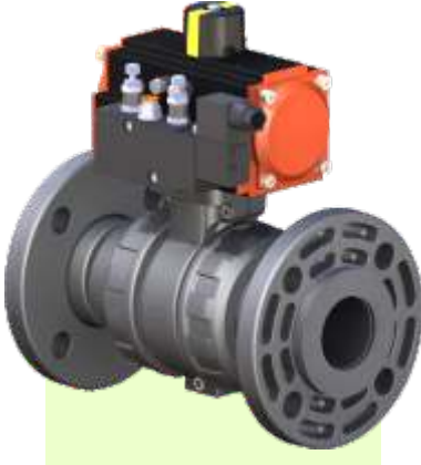
U-P.V.C. Küresel Su Vanası U-P.V.C. Water Ball Valve Basınç / Pressure : PN 10 Küre Contası / Seals : HDPE O-Ringler / O-Rings : EPDM
